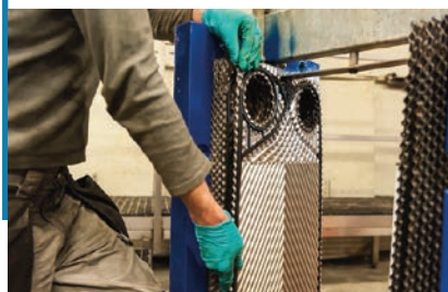
⑥ Chiusura con test in pressione dello scambiatore
