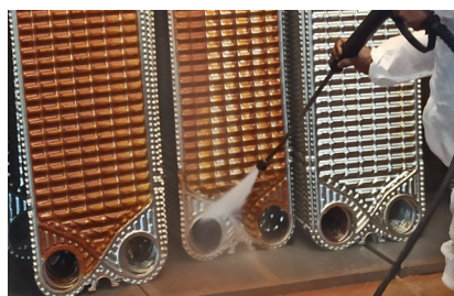
① Lavaggio ad alta pressione delle piastre
